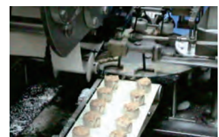
Forming and Aligning Automatically 燒賣自動排列成型
